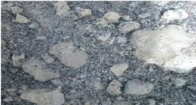
Ils consistent à des grains de charbon grossier non incinérés qui tombent par gravité au fond du four et sont récupérés avec les rejets
